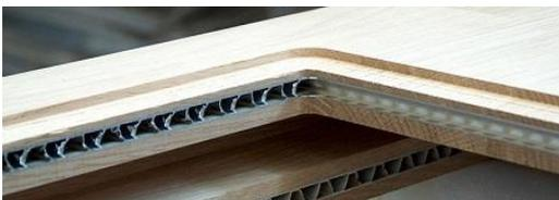
Panel resistente al fuego de extremada ligereza rigidez y planaridad. Puede ser revestido de cualquier material: piel, HPLC... o incluso anodizado y barnizado. Fuente: Materializa 2017. Abril 2017.
