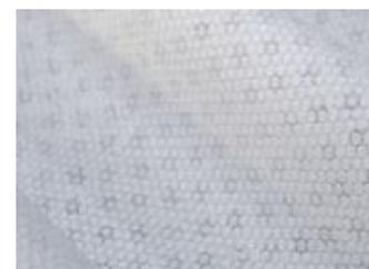
**Textil ignífugo con poca transmisión de calor**
