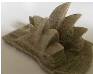
Científicos australianos han desarrollado un enfoque innovador para la impresión 3D de hormigón utilizando cemento y geopolímero aglutinante. A diferencia del método convencional de fundición de hormigón en un molde, la impresión 3D de hormigón combina tecnologías digitales y de materiales para permitir la construcción de forma libre sin el uso de encofrado. <http://imprimalia3d.com>. Texto y fotos IMPRIMALIA 3D. 09 Noviembre 2017.
